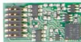
Digitaldecoder PluX12, ermöglicht zusätzliche Licht- und Soundfunktionen/PluX12 digital decoder, enables additional light and sound functions (20 x 9,5 x 3,5)*
