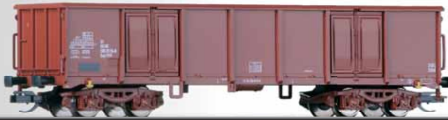
Offener Güterwagen Eas 5969 der DR mit Pressblech Türen Open car Eas 5969 of the DR with pressure plate doors
