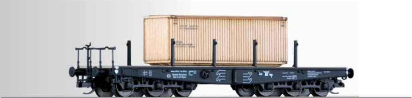
Schwerlastwagen SSyms Köln der DRG, beladen mit Holzkiste Flat car SSyms Köln of the DRG, loaded with a wooden box
