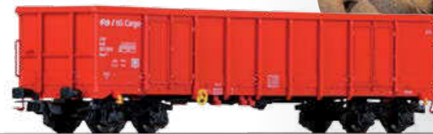
Offener Güterwagen Eanos der NS-Cargo, mit Schrottladung Open car Eanos of the NS-Cargo, with scrap metal loading
