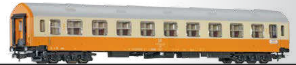
Reisezugwagen 2. Klasse „Städteexpress“, Typ Y/B 70, der DR 2nd class passenger coach, type Y/B 70, of the DR for fast intercity trains
