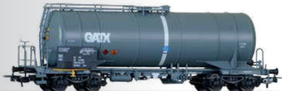
Kesselwagen Zaes der GATX, mit Heizeinrichtung Tank car Zaes of the GATX with heating amatures
