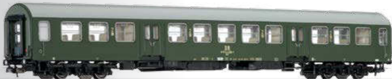
Nahverkehrswagen 2. Klasse der DR, Bauart Halberstadt 2nd class suburban coach of the DR, type Halberstadt
