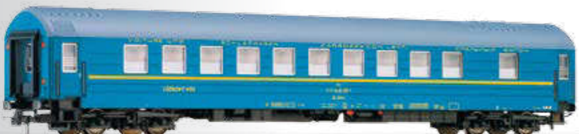
RIC-Schlafwagen 1./2. Klasse, Typ Y, der ČSD 1st/2nd class sleeping car RIC, type Y, of the ČSD
