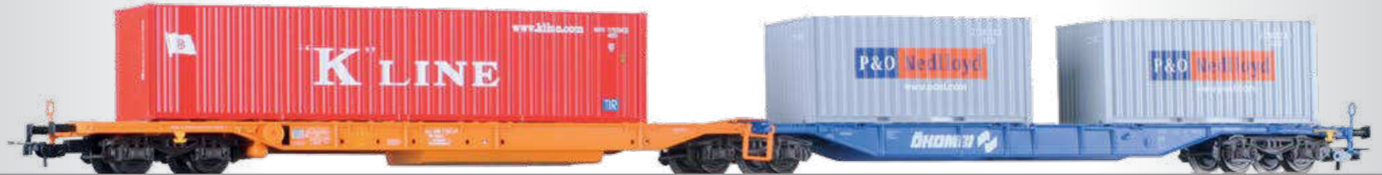
Doppeltragwagen Sdggmrss „Ökombi“ der ÖBB, beladen mit zwei 20" Container „P&O Nedlloyd“ und einem 40" Container „K Line“ Container car Sdggmrs „Ökombi“ of the ÖBB with two 20" containers "P&O Nedlloyd" and one 40" container "K Line"
