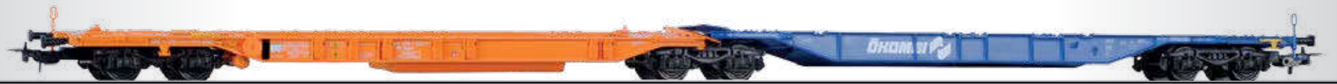
Doppeltragwagen Sdggnos/Sdggmrs 739/744 „Ökombi“ der ÖBB Container car Sdggnos/Sdggmrs 739/744 „Ökombi“ of the ÖBB
