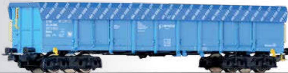
Offener Güterwagen Eanos der SBB Cargo, mit Plane Open car Eanos of the SBB Cargo with tarpaulin
