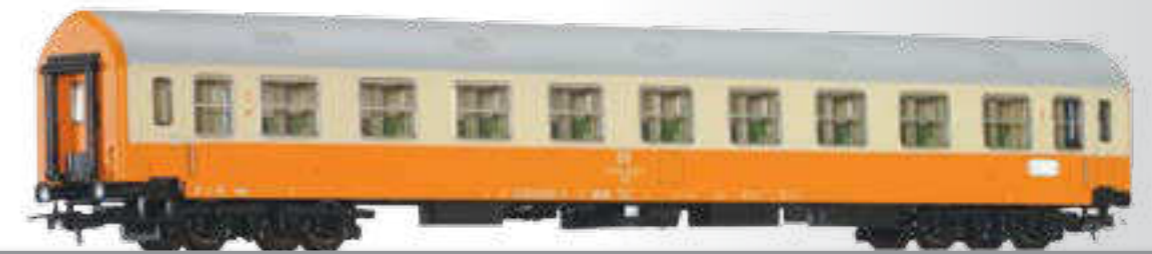
Reisezugwagen 1. Klasse „Städteexpress“, Typ Y/B 70, der DR 1st class passenger coach, type Y/B 70, of the DR for fast intercity trains
