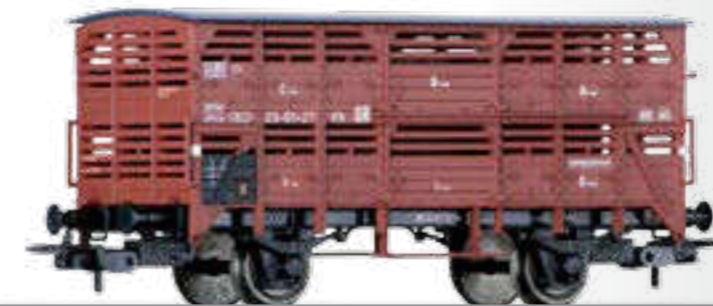
Verschlagwagen Vh 23 der DR Shed car for transport of animals Vh 23 of the DR
