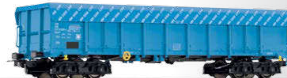
Offener Güterwagen Eanos der NS, mit Plane Open car Eanos of the NS with tarpaulin
