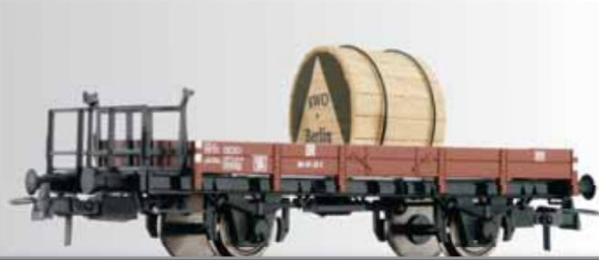
Niederbordwagen (ex Erfurt) der DR, beladen mit Kabelrolle (KWO Berlin) Low side board waggon (ex Erfurt) of the DR, with cable reel
