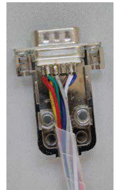
Ein Tipp zum Anschluss. Mit einer 9-poligen Sub-D Steckverbindung für die acht Anschlussdrähte ist man mobil und im Bedarfsfall nur der Antrieb zu demontieren. Zur Bündelung der Leitungen ist ein Spiralschlauch empfehlenswert.
