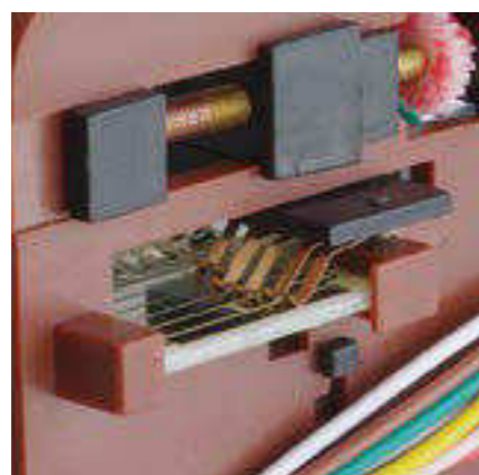
Beim Einsetzen des oberen Gleitstücks ist darauf zu achten dass die Kontaktfahnen nicht verbogen werden.
