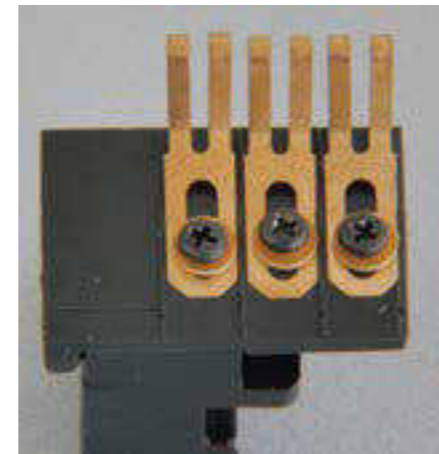
Am Gleitstück links ist die Symmetrielinie erkennbar. Je nach erforderlichem Stellweg sind die Kontaktfahnen zu positionieren.
