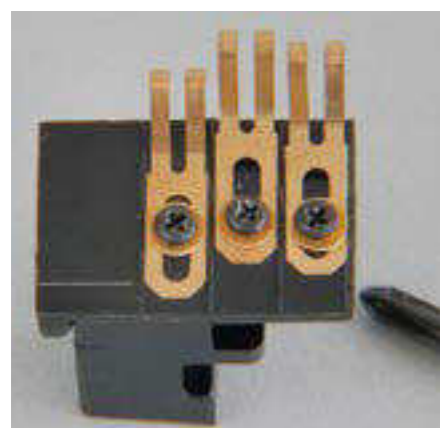
Die Symmetrielinie ist mit einem weißen Stift markiert. In dieser Position beträgt der Stellweg etwa acht Millimeter.
