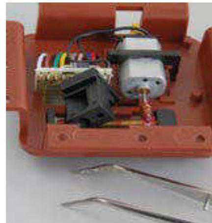
Nun wird das obere Gleitstück (mit einer Pinzette) um 45° gegen den Uhrzeigersinn gedreht nach oben herausgehoben.
