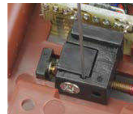
Der Stelldraht wird nach Lockerung der Spansschraube in dieser Position am Gleitstück befestigt.
