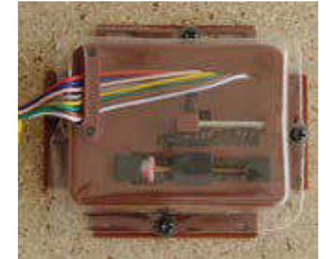
Der staubgeschützte und fertig montierte Antrieb. Drei Befestigungsschrauben samt Scheiben liegen dem Antrieb bei.
