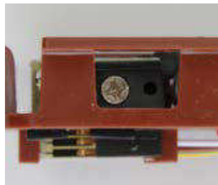
Zum Einstellen des Stellwegs muss sich die Spansschraube in dieser Position befinden, um sie herausdrehen zu können.
