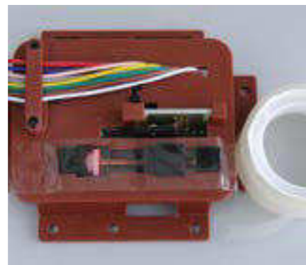
Vor dem Entfernen der Spansschraube ist der Antriebsstrang an der Unterseite mit Klebeband zu sichern.
