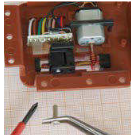
Die Spansschraube wird nun herausgedreht. Zum Herausziehen aus dem Getriebekasten ist eine Pinzette das richtige Werkzeug.
