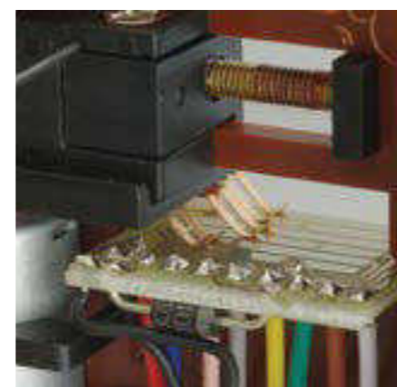
Das Bild zeigt deutlich die unterschiedlichen Positionen der Kontaktfahnen sowie den eingespannten Stelldraht.
