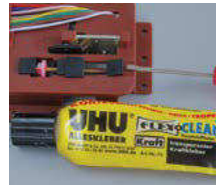
Alternierend zum Klebeband kann die Seite mit dem L-Profil mittels Kleber gesichert werden.
