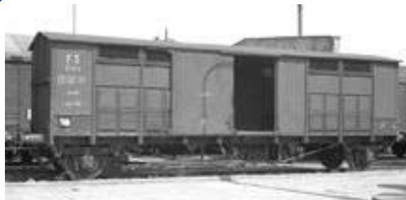
Gedeckter Güterwagen der Italienischen Staatsbahn. Gruppe EE, Modell der langen Bauart, Bj. 1937-42.
