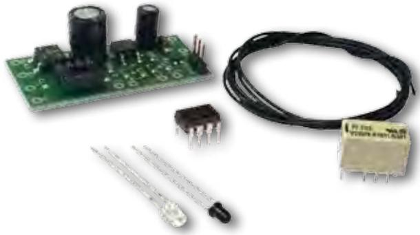
**Anwendungsbeispiele:** Ein Zug fährt durch die Lichtschanke, dadurch wird ein weiterer Gleisabschnitt stromlos geschaltet oder eine Bahnschranke (nicht im Lieferumfang enthalten) angesteuert. Diese hebt oder senkt sich.
